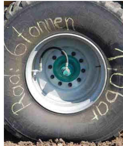
◀ Een snelwerkend drukwisselsysteem is de enige oplossing om met lage bandenspanning op het land te kunnen rijden en met een hoge bandenspanning op de weg. Een snel terugverdiende investering door minder brandstofverbruik én een sterk verminderde bodemverdichting.
